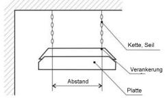
Abstände der Verankerungen auf der Hinterseite der Platte: Es wird empfohlen, nach Einsetzen die Position mittels Stellschrauben gegen zufälliges Herausfahren zu blockieren.
