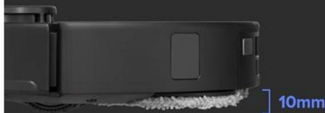
2. Basierend auf internen Roborock-Tests können die Wischmodule bis zu 10 mm angehoben werden.
