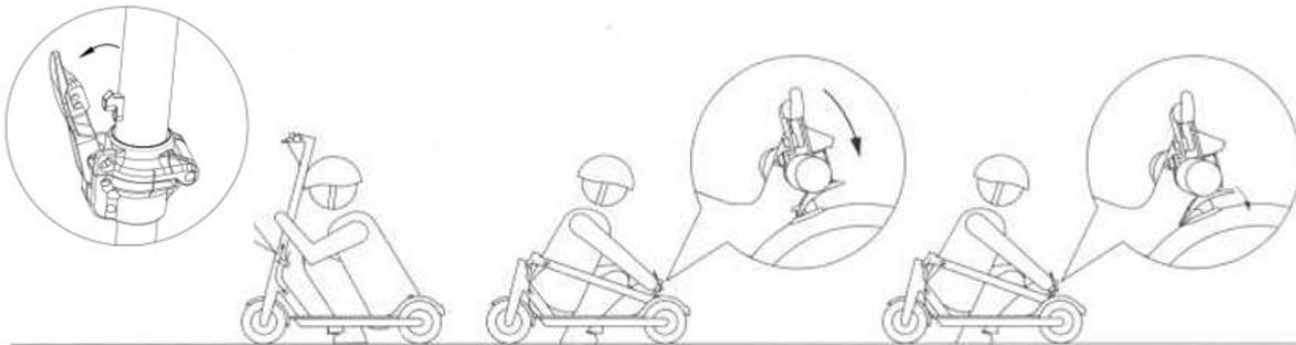
Stellen Sie sicher, dass der E-Scooter ausgeschaltet ist. Öffnen Sie die Klappvorrichtung. Legen Sie die Lenkstange um und sichern Sie diese, indem Sie diese an der Kotflügel befindlichen Klapphalterung einhaken.
