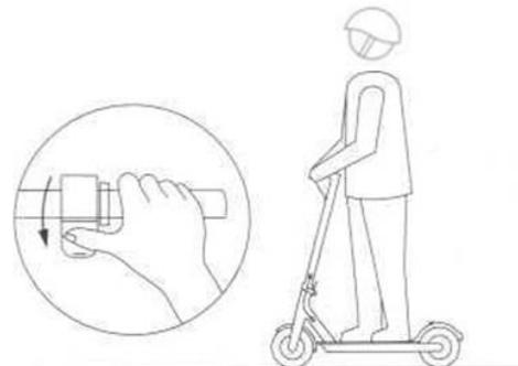
3. Stellen Sie nun auch den zweiten Fuß hoch, sobald der Scooter in Bewegung ist und drücken Sie dann den Gashebel um zu beschleunigen (beschleunigt nur, wenn die Geschwindigkeit des Scooters 5 km/h überschreitet = Kick-Start).
